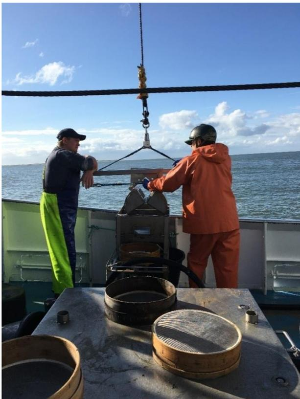
**Abb. 2:** Van-Veen-Greifer (0,1 m<sup>2</sup> Fläche) und Siebe für die Erfassung der Infauna.
