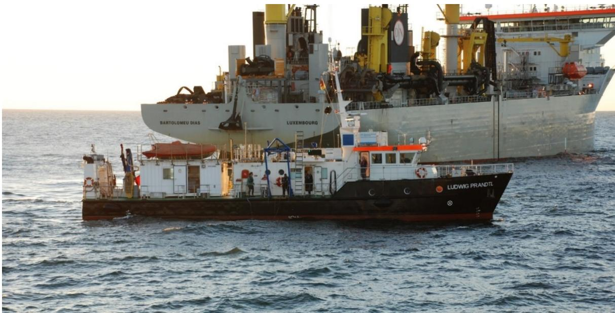
**Abb. 2:** ADCP-Schwebstoffmessung mit der Ludwig Prandtl. © HPA, Behrend
