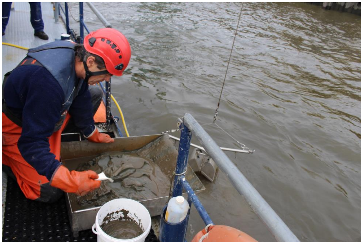
Abbildung 1: Entnahme von Sedimentproben im Hamburger Hafen (Foto: J. Sprenger).
