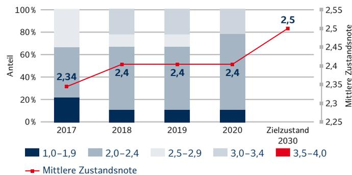
Abb. 4: Zustandsentwicklung Bahnbrücken
