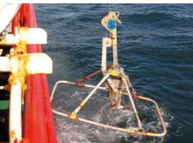
Kastengreifer zur Entnahme ungestörter Proben
