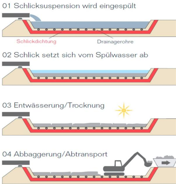
Abb. 18 Verfahrensprinzip der Entwässerungsfelder.
